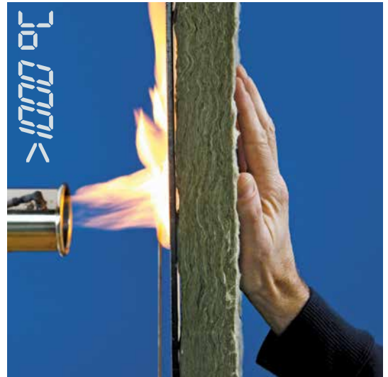
Steinwolle hat einen Schmelzpunkt von über 1000 °C. Mit einer vollflächigen Dämmung mit COMPACT PRO kann auf Brandriegel verzichtet werden. So einfach geht's.
